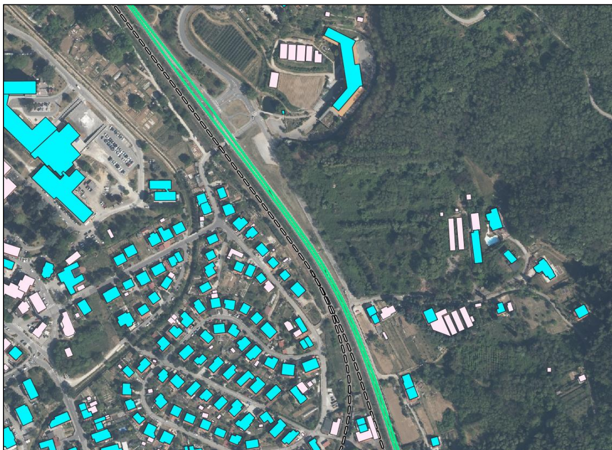
Slika 2: Obstoječe prometno omrežje in pozidava v okolici obravnavanega OPPN (zelena glavna cesta, črtkana železniška proga, modre stavbe z varovanimi prostori, ržnate stavbe brez varovanih prostorov).
